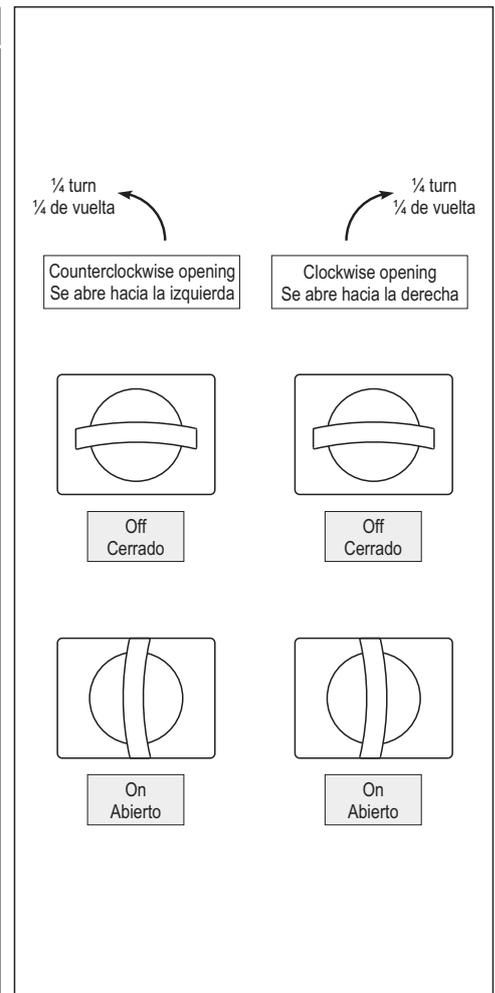
**HANDLES INSTALLATION ● INSTALACIÓN DE LAS MANILLAS**
