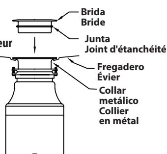
**3** Lubrique con agua la junta de la brida e insértela despacio dentro del collar metálico. Presione con fuerza hasta que esté en su lugar.
