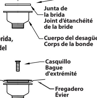
**4** Alinee las nervaduras del cuerpo del desagüe y la brida del filtro, y luego ajuste el casquillo. Precaución: Ajuste manualmente, luego gire 1/4" con un destornillador pequeño. No ajuste en exceso. Retire el sellador / adhesivo sobrante.
