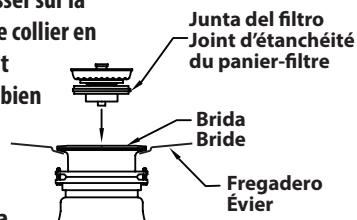
**4** Lubrique con agua la junta del filtro e insértelo despacio dentro de la brida.
